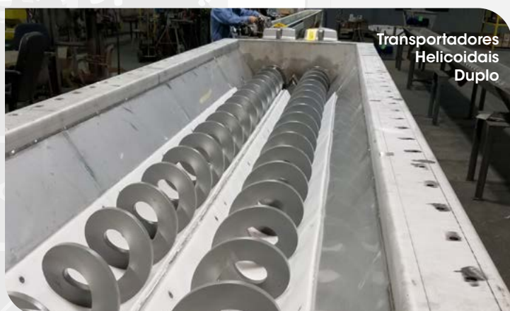
Helicoidal Shaftless com liner de UHMW transportando grãos úmidos e pegajosos de cevada.
