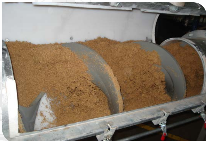
Helicoidal Shaftless com liner de UHMW transportando grãos úmidos e pegajosos de cevada.
