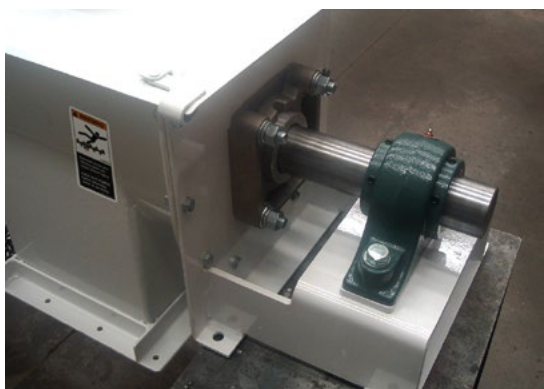
Vedação do eixo na tampa final
