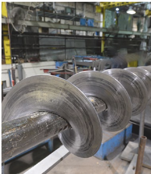
Hélice contínua formado a frio
