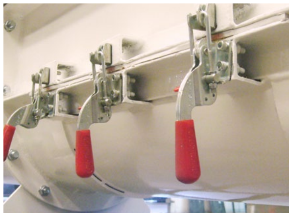
Os grampos de alavanca mantêm fechada uma seção da calha inferior que pode ser aberta para facilitar a manutenção, limpeza e inspeção
