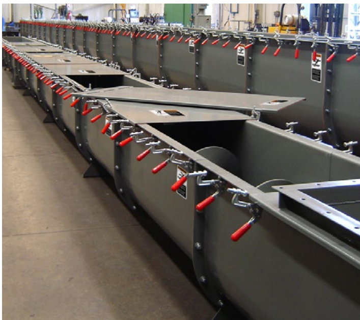
Tampas mantidas fechadas com grampos em todo o comprimento do transportador helicoidal
